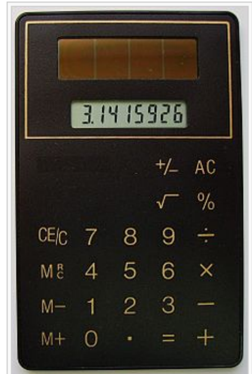
Calculatrice solaire portable. Un « concentré » de technique, à prix dérisoire, dans une dizaine de grammes : cellule photovoltaïque, microprocesseur et afficheur à cristaux liquides (années 1980).
